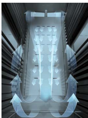
Umluftsystem mit Luftleitblech
